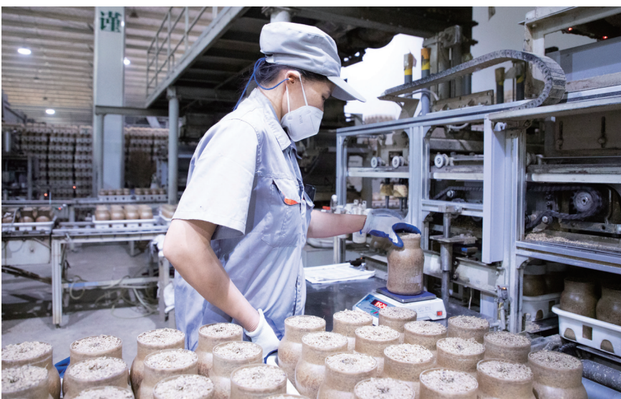
图为工人正在蘑菇菌丝生产车间内将培养基称重配料、均匀搅拌后装瓶。
