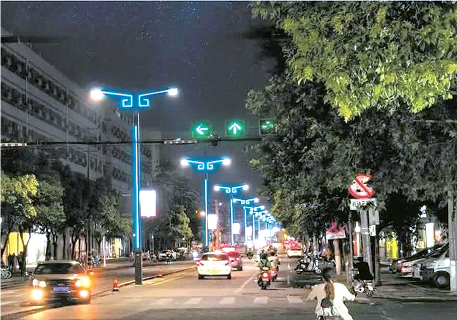
兖州区积极响应绿色发展号召，探索智慧城市照明及公共设施节能升级改造的可持续发展路径，携手浪潮集团，采用合同能源管理（EMC）模式，通过“政府零投入、企业全程运维、节能收益共享”的创新机制，对城市照明系统进行升级改造，年综合节能率达65%以上，减少碳排放超1.2万吨。
