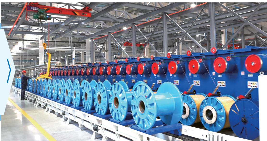
华勤高端橡胶新材料产业园年产10万吨高强度钢帘线项目,主要生产高性能、新结构、轻量化的高端钢帘线,为全球高端轿车轮胎、卡车轮胎、工程机械轮胎等提供高品质的钢丝骨架材料。产品制造工艺符合行业最高标准,既满足“双碳”战略背景下橡胶轮胎行业绿色低碳、高效节能的发展要求,又满足高性能轮胎制造对骨架材料的需求。图为华勤高强度钢帘线生产车间。 ■记者 刘建新 摄
