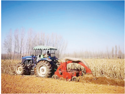
直注式秸秆还田作业现场
