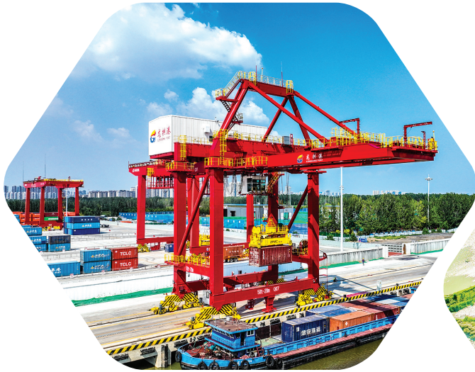
龙拱港：正在进行全自动化的集装箱装卸作业
