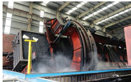
梁山港万吨列车智能自卸车机房正在卸载煤炭
