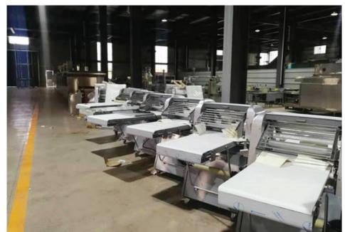
无压蛋糕生产线、全自动包装机等多种自动化、智能化食品机械。实现了仿生模拟技术、异形隧道成型、光感应自动判断面团醒发成型、温度压力时间烘烤曲线控制、连续换向压延面团成型、全自动摆放、自动称重等多项技术突破。
