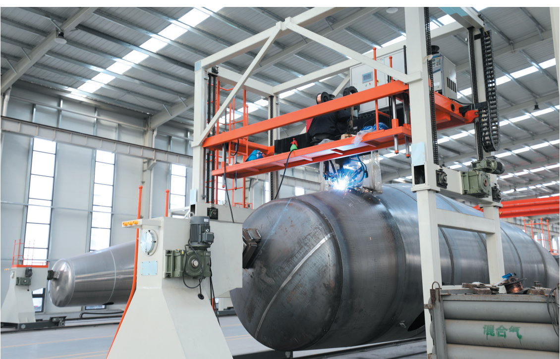
近年来,梁山县持续高扬“工业立县”的大旗,以“创新、创造、创品牌”为抓手,全力抓技术装备改造,提升企业自动化水平,提高产品附加值,提升企业核心竞争力。图为曙岳公司粉罐车生产车间,一台数控龙门焊冒着火花,正在对专用车罐体进行焊接作业。
