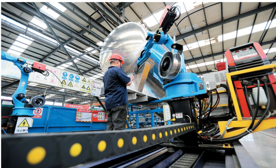
近年来,梁山县持续高扬“工业立县”大旗,全力抓技术装备改造,提高产品附加值,提升核心竞争力。图为华宇公司专用车生产车间内的智能焊接机器人工作站。公司在关键工序采用智能装备后,运营成本降低3%,关键工序焊接质量合格率提高5%,生产效率提高了10%以上。
