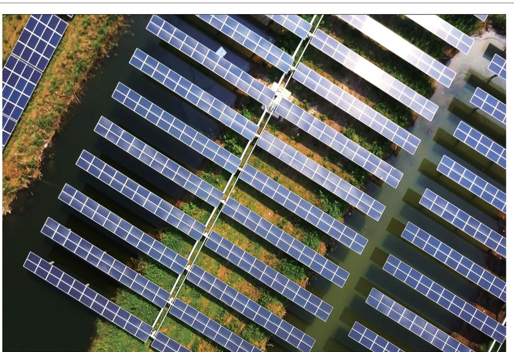
微山县以渔光互补、农光互补为依托,在塌陷地建设光伏发电项目,将光伏发电与传统农业、渔业建设相结合,实现对土地资源的立体综合利用,围绕采煤塌陷地治理探索因地制宜、综合治理、高效利用的新模式。图为中微微山采煤沉陷区50MW光伏发电示范项目。
