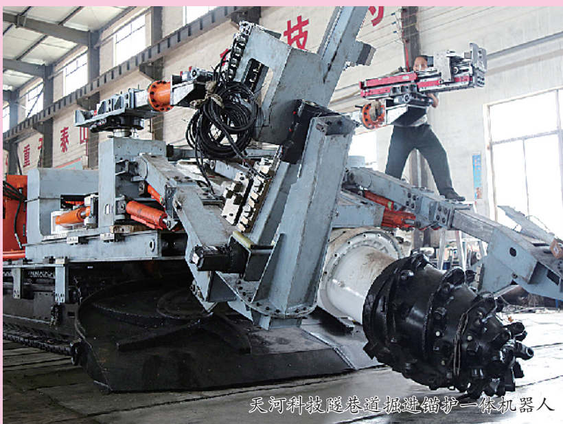
天河科技隧巷道锚护一体机器人
