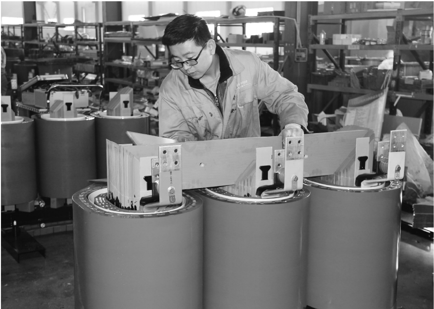
今年以来,汶上县立足产业基础和特色优势,改造提升纺织服装、装备制造、盐煤精细化工三大主导产业,培育发展新兴产业,着力打造“3+1”产业体系。深入推进工业化、信息化“两化融合”,利用新技术、新产业、新业态、新模式,改变传统生产方式,促进生产方式向柔性、智能、精细、绿色转变,推动产业链向两端延伸、价值链向高端攀升。促进传统产业推陈出新、提档升级。图为华尚电气三角形立体卷铁芯节能配电变压器生产项目。 ■胡克潜 摄 / 撰
